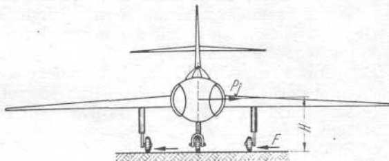
Rys. 3-275 Niestateczność samolotu w czasie zakręcania na ziemi
